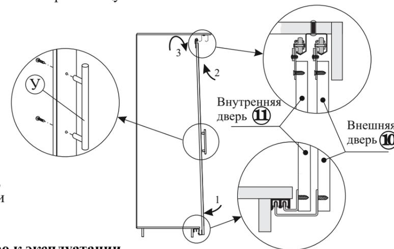
3.10. Установите планку (дет.№9), закрепив ее винтовой стяжкой (поз.А). Установите ручки (поз.У).
