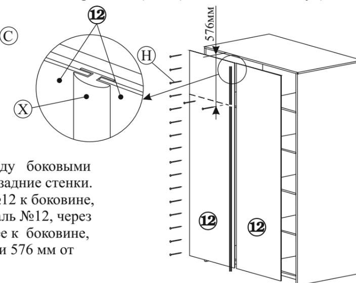
3.7. Выровняйте шкаф так, чтобы между боковыми стенками и дном был прямой угол. Установите задние стенки. Для этого: Закрепите гвоздями (поз.Н) Деталь №12 к боковине, дну и крышке. Затем присоедините вторую деталь №12, через стыковочный профиль (поз.Х), и закрепите ее к боковине, дну и крышке. И к полке (дет.№5) на расстоянии 576 мм от верхней плоскости крышки (дет.№3).
