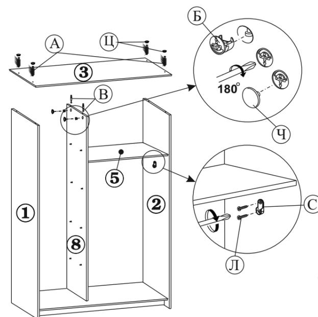
3.6. В крышку (дет.№3) вкрутите два штока эксцентрика (поз.В). Затем установите крышку на каркас шкафа, закрепив ее винтовыми стяжками с боками (дет. №1 и №2) и установив эксцентрики (поз.Б) в перегородку (дет.№8) поверните их на 180 градусов по часовой стрелке. На деталях №2 и №8, под полкой (дет.№8), шурупами закрепите штангодержатели (поз.С). Установите штангу (поз.Т).
