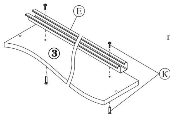
3.1. При помощи межсекционной стяжки (поз.К), закрепите на крышке,(дет.№3) верхний ходовой профиль (поз.Е).
