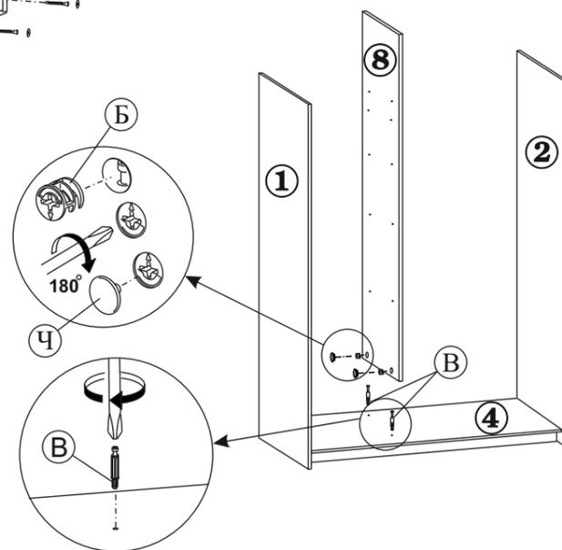
3.5. В детали №2 и №8, вкрутите дюбели ввинчиваемые (поз.О). Установите на них полку (дет.№5). Зафиксируйте ее повернув винты вмонтированных в полку эксцентриков по часовой стрелке на 180 градусов. В детали №1 и №8, установите полкодержатели (поз.П).
