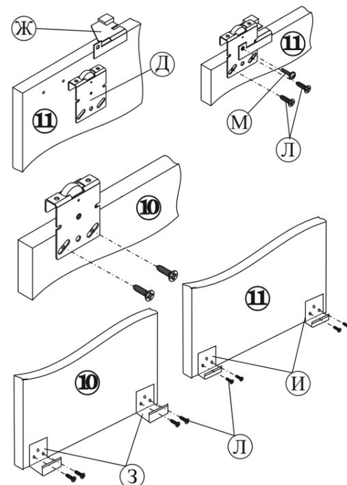
3.8. На двери (дет.№10,11) установите ходовые ролики (поз.Д) и стопор (поз.Ж) на внутреннюю дверь (дет.№11). Причем стопор ставится на ролик находящийся ближе к боковине шкафа, а амортизатор стопора направлен к центру шкафа. Для крепления стопора к ролику используйте винт (поз.М). На внешнюю дверь (дет.№10) устанавливаются ролики без стопора.
