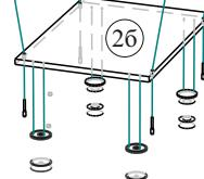
После сборки рекомендуем выставить по месту пенал, отрегулировать высоту с помощью опор, скрепить его межсекционной стяжкой с соседними модулями (отверстие под стяжку сверлится **самостоятельно** сверлом Ø 5-6мм), навесить фасады.
