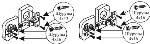
После сборки рекомендуем выставить по месту пенал, отрегулировать высоту с помощью опор, закрепить его межсекционной стяжкой с соседними модулями (отверстие под стяжку сверлится **самостоятельно** сверлом Ø 5-6мм), навесить фасады.
